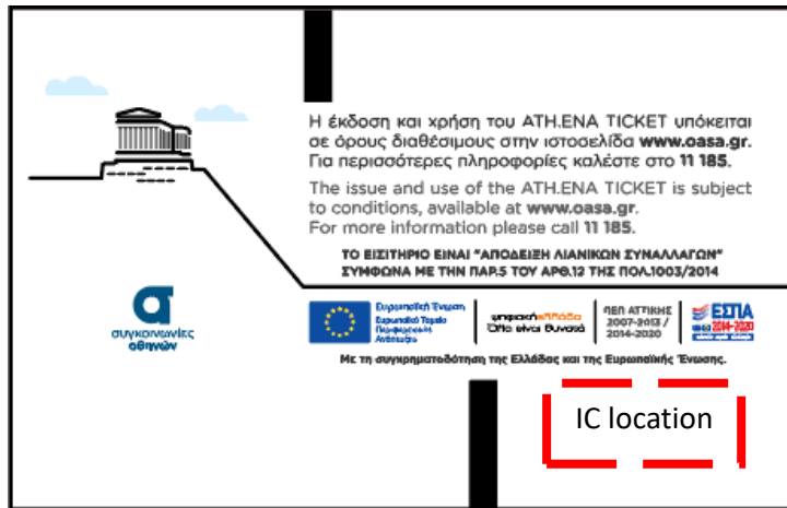
Εικόνα 2.2 Μορφή εισιτηρίου ρολού πολλαπλού με σήμανση Blackmarks και θέση IC
